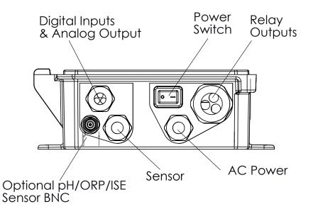
**Figure 1 Conduit Wiring**
